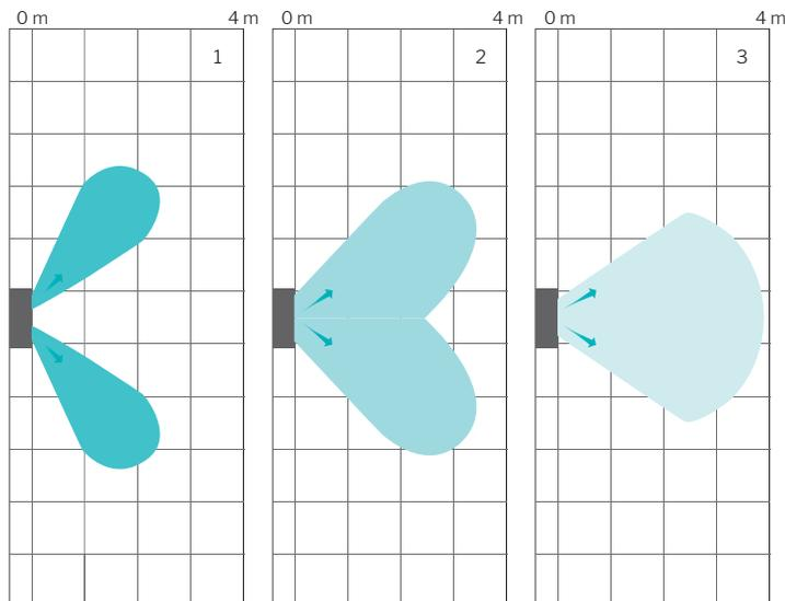
La centrale diffuse l'air soufflé en fonction du réglage des lamelles.
