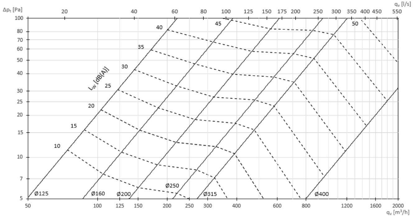
Figure 1: Débit d'air  $q_v$  [l/s] ; [m³/h], perte de charge totale  $\Delta p_t$  [Pa], et niveau de puissance acoustique [dB(A)]
